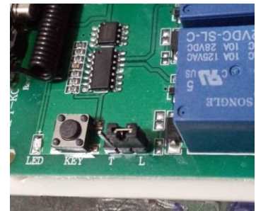
Modo Esclusa (jumper en L)
