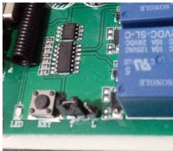
Modo Bloqueo (jumper en T)
